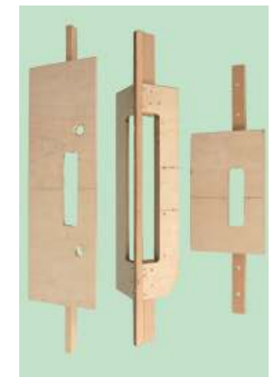
Abb. Frässhablonen für Oberfräse
