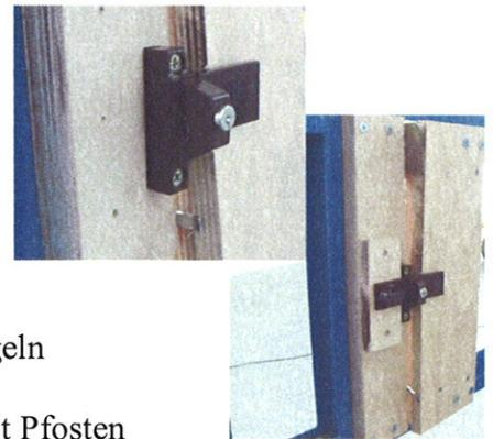
**Bauart** Fenstersicherungen als aufschraubbare Nachrüstprodukte alternativ mit einhängbaren oder einschwenkbaren Riegeln in Sockel für Profilmontage für einflügelige und zweiflügelige Fenster mit Pfosten
